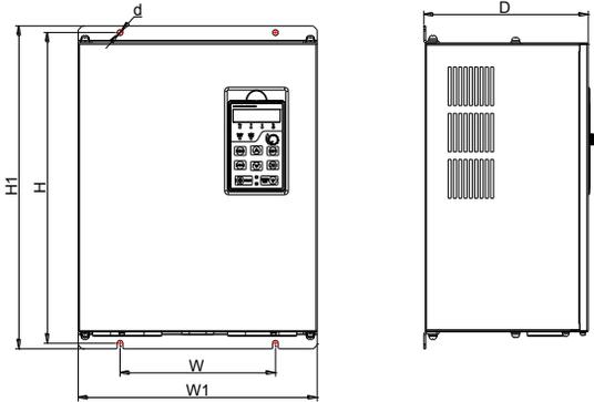
图.3 产品安装尺寸
