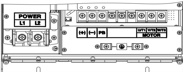
图 5 15-22KW 主回路端子
