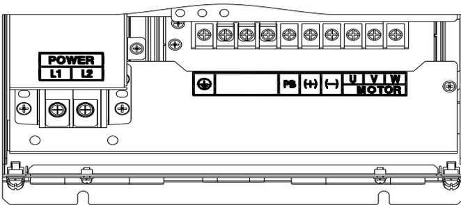
图 4 4.0-11KW 主回路端子
